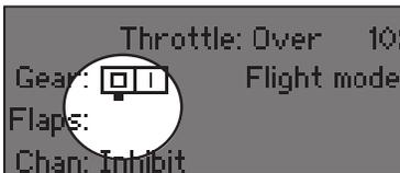
**Tip:** Der schwarze Punkt unter dem Kästchen zeigt die aktuelle Schalterposition. Drehen und drücken den Rolltaster markiert die Box schwarz und zeigt damit an, dass der Wert oder die Bedienung auf dieser Position liegt.
