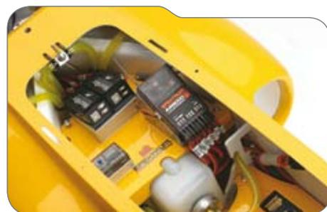
Bob Violett Model Bandit ARF Installation. Der Einbau des AR9000 und des Flugschreibers von Bill Brundle ist beispielhaft. Beachten Sie den Einbau der Satellitenempfänger. Einer sitzt in der Nase und ein zweiter im Seitenleitwerk
