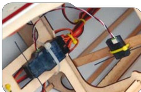
Einbau des AR7000 Empfängers in die turbinengetriebene Quique YAK von Jeff Holsinger. Dank der 2.4GHz Technologie ist es nicht nötig den Empfänger gegen Vibrationen der Turbine und Luftschraube abzuschirmen.
