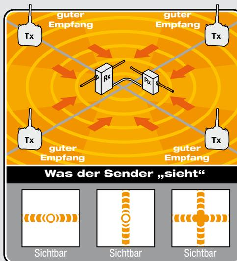
2.4GHz Systeme unterliegen der Signal Polarisation, die dazu führt, dass die Antenne des Empfängers in bestimmten Ausrichtungen einen schlechteren Empfang aufweist. Dieses Problem wird durch die Spektrum Weg Diversifikation gelöst, indem man zwei Empfänger einsetzt, die um 90° versetzt ausgerichtet sind. Das Sendersignal wird nun immer eindeutig erkannt, unabhängig von der Fluglage des Modells.
