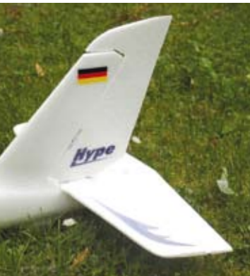
Das Höhenleitwerk ist abnehmbar und wird durch den Rumpf mit einer M3-Schraube gesichert
