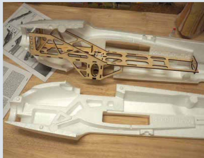
M-Frame bereits in rechter Rumpfhälfte verklebt.
