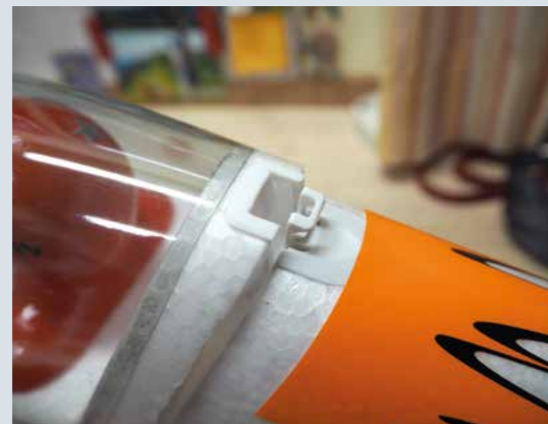
Sicherer Schnappverschluss der Kabinenhaube, „es muss KLICK machen“!
