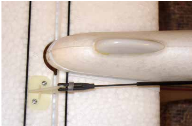
Da ja sämtliche Ruderfunktionen werkseitig schon programmiert sind, sollten die Ruder mittig stehen und in die richtige Richtung ausschlagen. Um dies zu überprüfen, empfiehlt die Bedienungsanleitung, dies im Expertenmodus durchzuführen.
