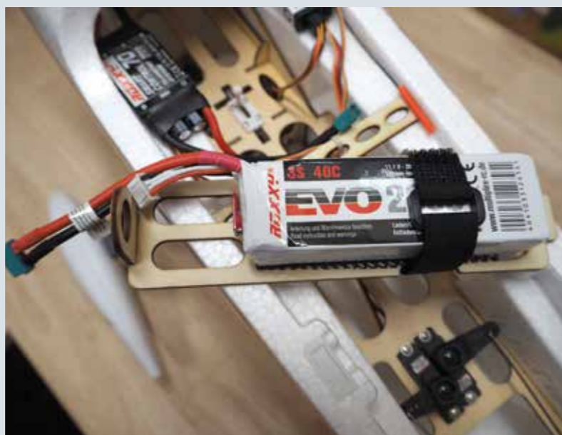
3s Lipoakku auf abnehmbaren Akkubrett zum einfachen Tausch außerhalb des Modells.
