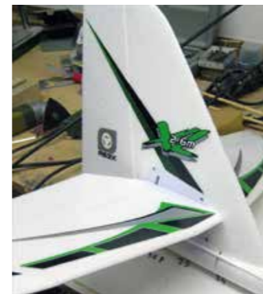
Das sehr stabil gelagerte Pendelhöhenruder.
