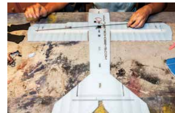
Begonnen wird der Bau mit dem Rumpf-Mittelteil und der mittleren Tragfläche. Zur Verstärkung führt ein Carbonstab durch Rumpf und Tragfläche.
