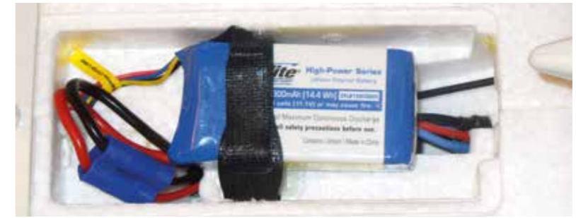
Der 3s-1.250 mAh Flugakku hat seinen Arbeitsplatz in einem Fach auf der Unterseite des Rumpfes, der durch eine abnehmbare durchsichtige Kunststoff-Klappe vor Verschmutzung geschützt ist.
