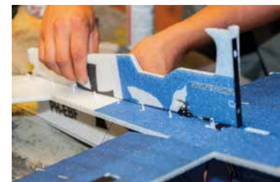
Die Rumpfteile werden mittels Carbonstäben verstärkt. Als Besonderheit besitzt das Modell im Mittelteil des Rumpfes einen Carbonholm, der durch Tragfläche und Rumpf führt.
