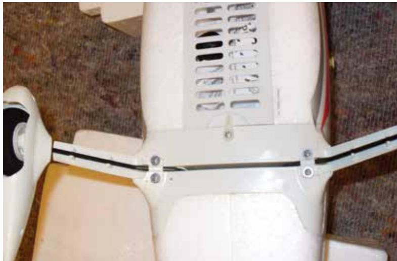
Die Montage des Hauptfahrwerks und der Beinabdeckungen gehört zu den wenigen Montagearbeiten, die noch zu erledigen sind.
