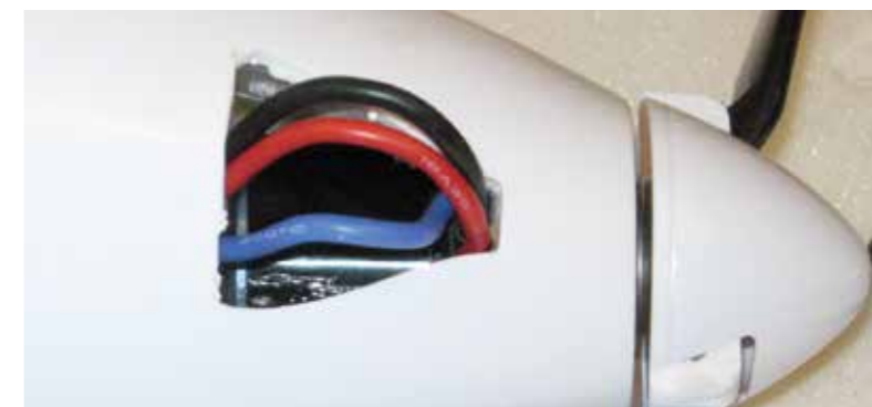
Achtung!! Hier müssen die Motorkabel immer etwas herausgezogen werden, sonst schleifen sie am Gehäuse des Motors.
