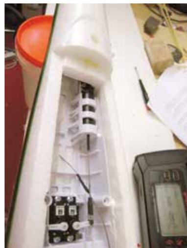
Alles eingebaut, im Hintergrund das CFK-Verstärkungsrohr des Rumpfes.
